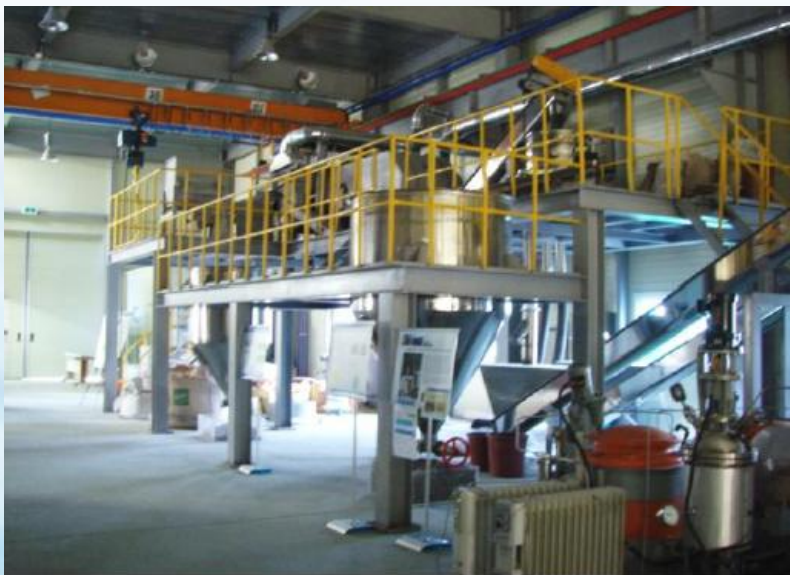
韩国：焚化炉灰固碳中试装置
