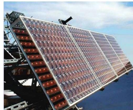
Концентраторная солнечная фотоэнергоустановка с системой слежения за солнцем
