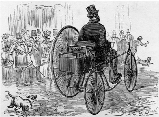
Fig. 13 : Tricycle électrique de Trouvé (Alexis Clerc, Physique et chimie populaires, vol. 2, 1881-1883).
