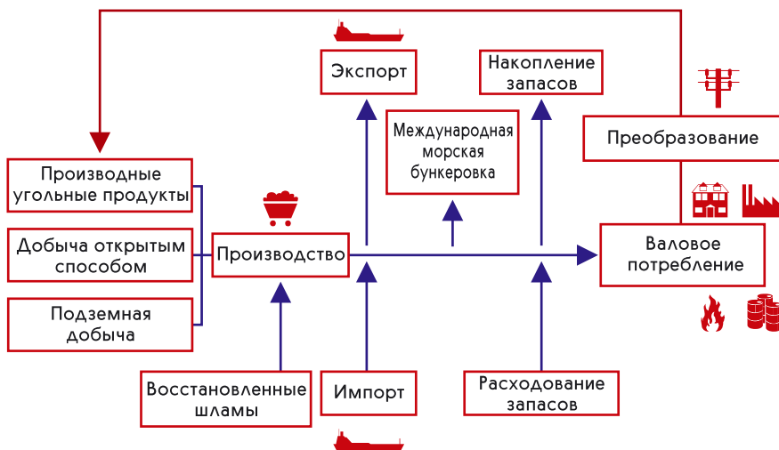
Рис. 5.1. ● Упрощенная схема потоков углей
