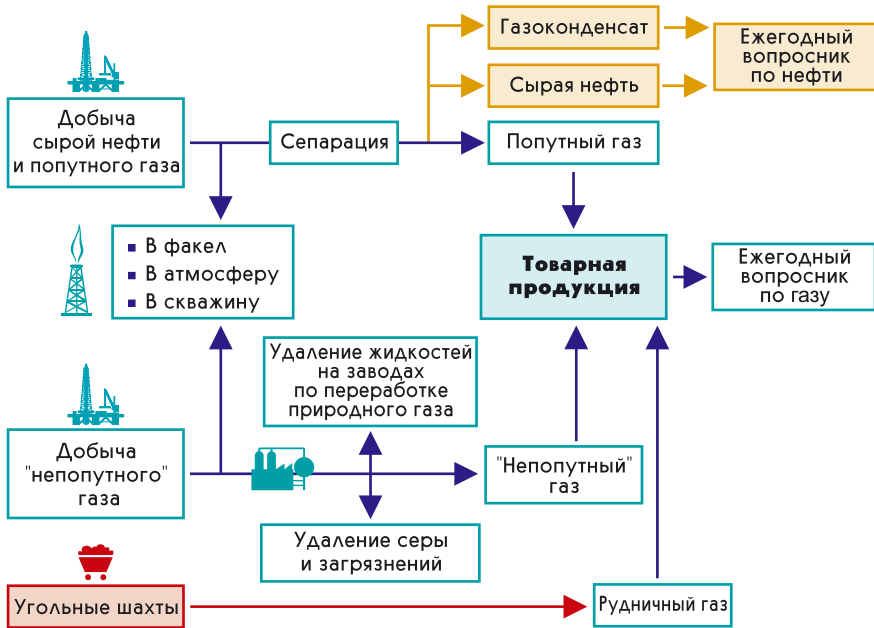
Рис. 3.3. Упрощенная схема потоков производства природного газа
