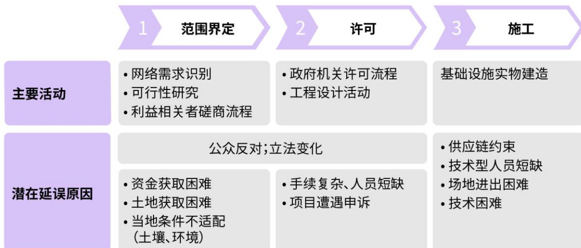
电网基础设施项目开发的各个阶段及可能造成延误的原因
